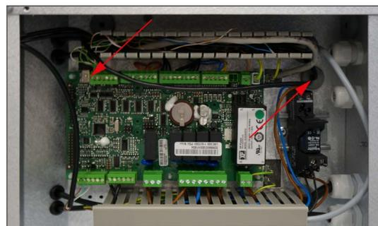
5. Den Fühler und den Feuchtigkeitssensor durch die Tülle im Fach am Gerät links ziehen.
