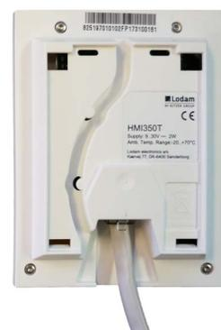
Der RJ12 Stecker wird von unten in die Buchse des HMI Panels geklickt und dann entlang der Mauer nach unten, in die Wand oder in die Nut auf der Rückseite des Panels geführt.
