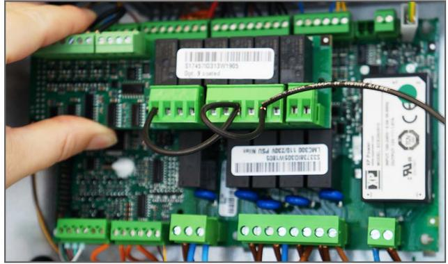
4. Die Zusatzplatine auf der CTS602 Platine montieren.
