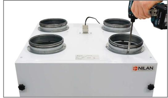
2. Den Außenluft Stutz wird abmontiert.
