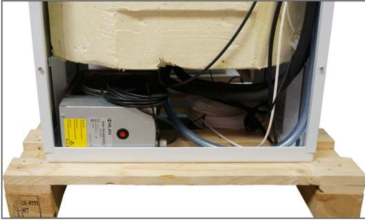
1. Das Elektro-Vorheizregister befindet sich unter dem Gerät.
