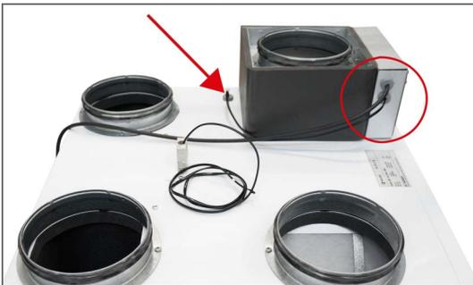
5. Der Temperatursensor für die Vorheizfläche wird 8 cm in die Tülle geschoben. Danach kann es im Inneren des Geräts direkt über dem Außenluftfilter hängen gesehen werden.
