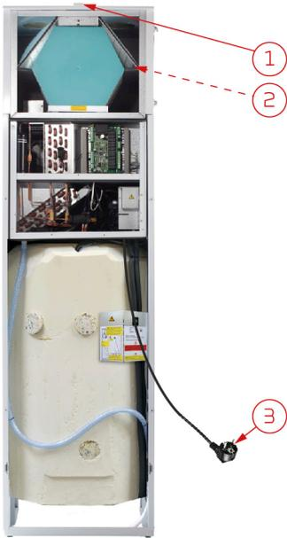
Ein 230V-Anschluss und den Anschluss des Vorheizregister befindet sich hinter der großen Tür des Geräts. Das Kabel lässt sich an der Hinterseite des Geräts am Boden herausführen. Die Verbindung zur Steuerung über USB-Kabel befindet sich hinter der Filtertür. Der 8-polige Stecker befindet sich oben am Gerät.
